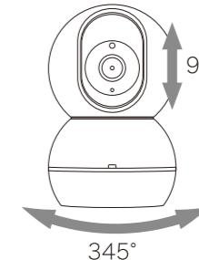
カメラを回転させて任意の位置にカメラの向きを移動させることができます。駆動範囲は水平方向345°、垂直方向90°です。
