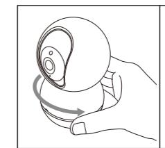
マウントブラケットの突起部とカメラ本体下部の爪を噛み合わせるように、カメラ本体を90°回転させて固定します。
