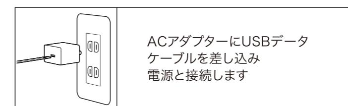
ACアダプターにUSBデータケーブルを差し込み
