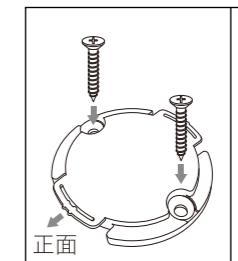
カメラを固定して設置したい場合には、マウントブラケットの突起部をカメラ正面/背面となるように配置して、付属のビスで固定してください。必要に応じて、アンカープラグをご利用ください。
